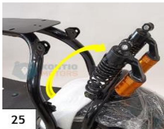
Käännä takajouset kuljetusasennosta pystyyn. (kuva25).
