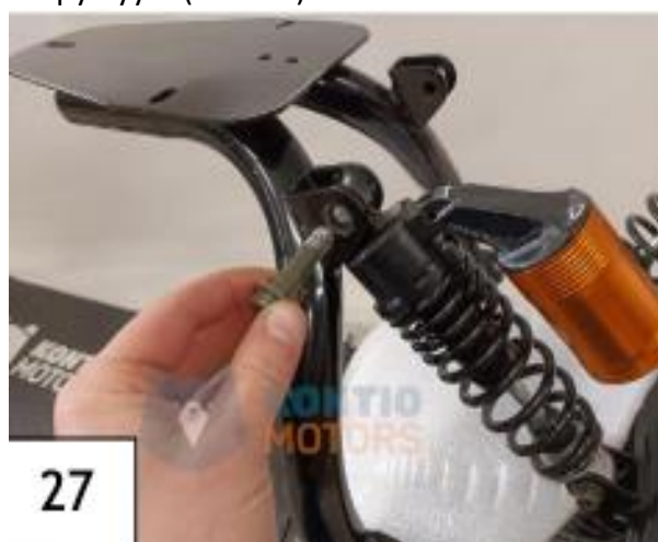
Laita takajousten yläpään pultti paikoilleen. (kuva27).
